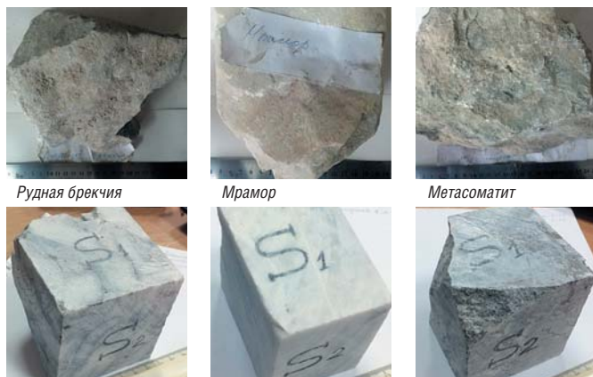
Рис. 2 Отобранные монолиты и изготовленные из них образцы для испытания соответственно
